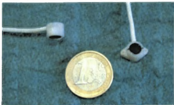
Εικ. 44. Ειδικού σχεδιασμού μεταλλάκτες υπερήχων, οι οποίοι εμφυτεύθηκαν χειρουργικά επί του οστού εκατέρωθεν της οστεοτομίας (διακρίνονται οι οπές στα πλάγια και η εγκοπή στην πάνω επιφάνεια του περιβλήματος του μεταλλάκτη για την υποδοχή του ράμματος).
