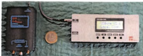
Εικ. 45. Φορητή συσκευή για την ευόδωση και παρακολούθηση της πύρωσης με LiUS. Αριστερά φαίνεται το δομοστοιχείο παραγωγής και λήψης υπερήχων (Sensing Module, SI) και δεξιά το δομοστοιχείο ελέγχου (Control Module, CM). Η συσκευή μπορεί να βρίσκεται συνεχώς πάνω στον ασθενή (wearable device).
