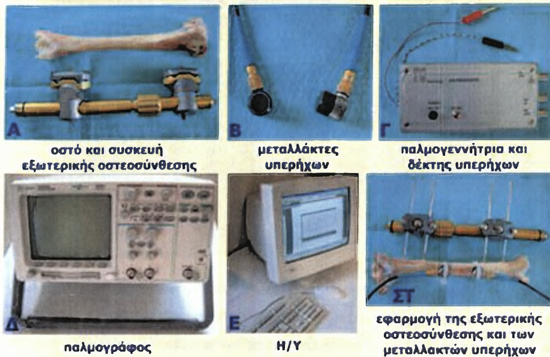
Εικ. 39. Στην εικόνα παρουσιάζονται τα επιμέρους στοιχεία της πειραματικής διάταξης για τη μελέτη της διάδοσης των υπερήχων στα οστά in vitro .
