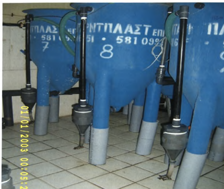
Εικόνα 3.1α. Σύστημα συλλογής περιττωμάτων πειραμάτων πεπτικότητας
