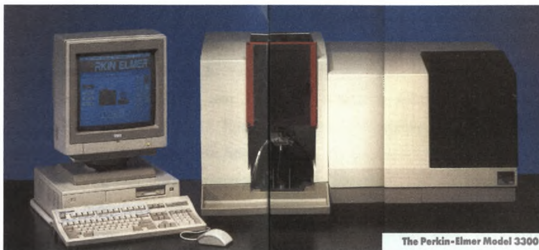
Εικόνα 6 Φασματοφωτόμετρο Ατομικής Απορρόφησης Perkin Elmer 3300. Εργαστήριο εδαφολογίας Πανεπιστημίου Θεσσαλίας
