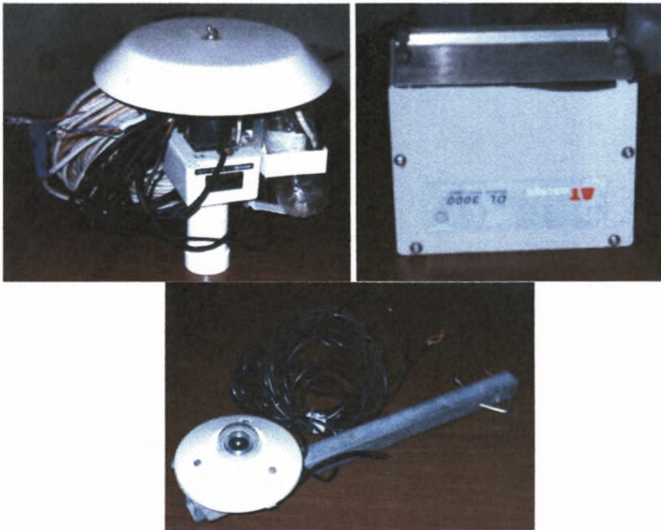
Εικόνα 12: Ψυχρόμετρο, Data logger και Πυρανόμετρο.
