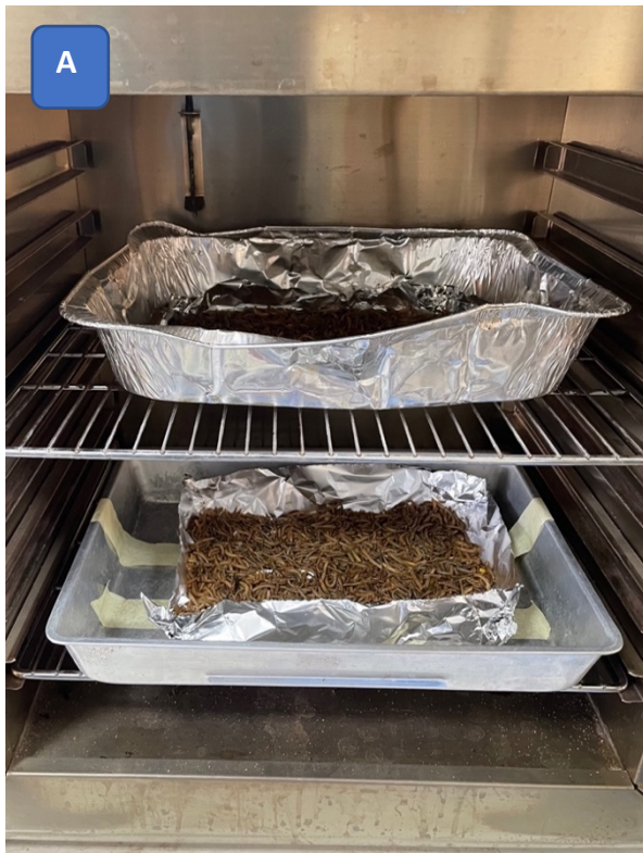
Εικόνα 15: A) Ξήρανση προνυμφών στον φούρνο, στους 105 °C για 24 h, B) Άλεуро από προνύμφες T. molitor , το οποίο χρησιμοποιήθηκε για τις αναλύσεις
