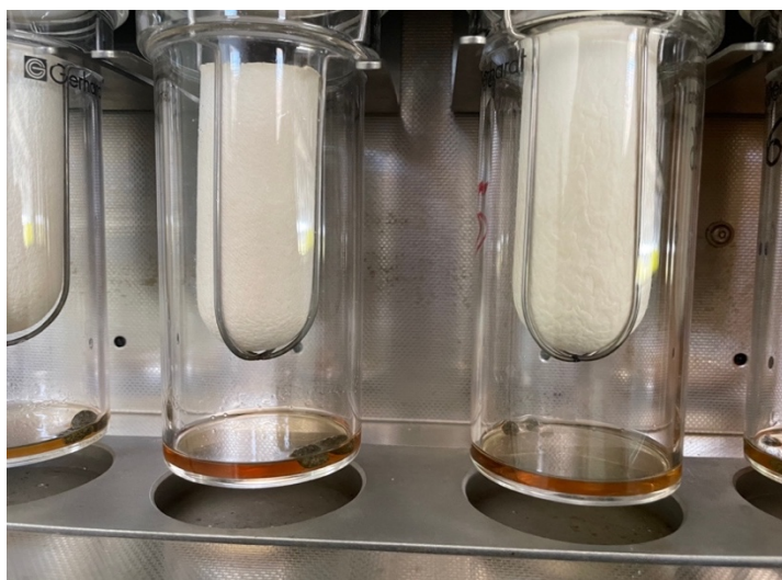
Εικόνα 17: Γυάλινα δοχεία εκχύλισης, με τους χάρτινους ηθμούς, στους οποίους περιέχονται τα δείγματα & ολικά λιπίδια των δειγμάτων στον πάτο των δοχείων
