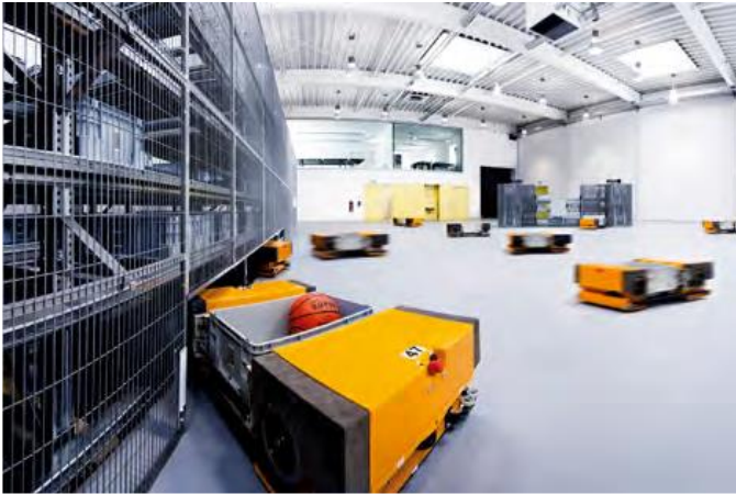
Εικόνα 7: Τα σμήνη οχήματα κινούνται γρήγορα και αυτόνομα στον χώρο της αποθήκης Πηγή: (DHL, 2014)
