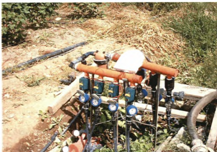
Εικόνα 1 Προγραμματιστής και οι 6 ηλεκτροβάνες
