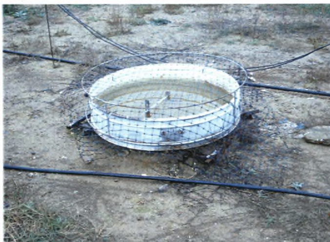
Εικόνα 2 Το εξατμισίμετρο που χρησιμοποιήθηκε
