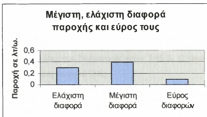
Σχήμα 6.1.4 Μέγιστη-ελάχιστη διαφορά παροχής μεταξύ πρώτου και τελευταίου σταλάκτη στον αγρό.
