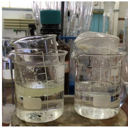
Εικόνα 2: θέρμανση φάσεων σε υδατόλουτρο
