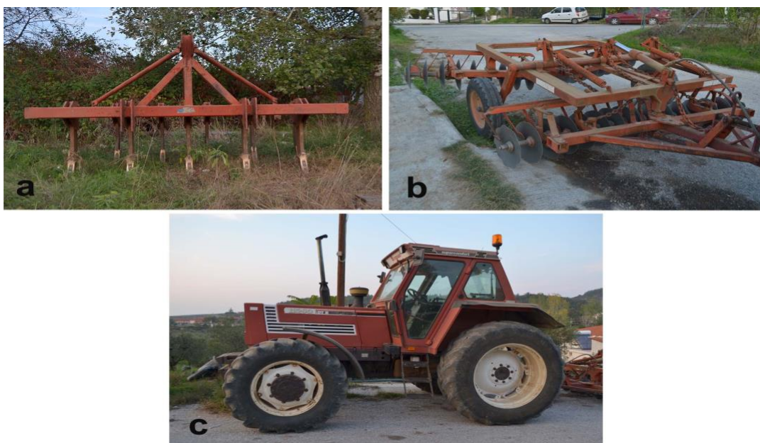
Εικόνα 13. Μηχανήματα που χρησιμοποιήθηκαν στους χειρισμούς 1 και 2. (a) εδαφοσχίστης, (b) δισκοσβάρνα διπλής ενέργειας, (c) γεωργικός ελκυστήρας.
