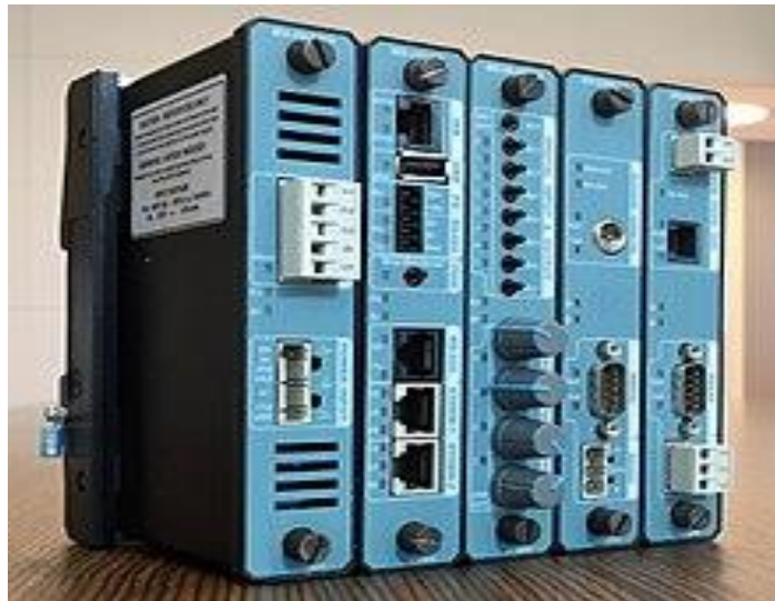
Εικόνα 26 Μονάδα RTU ( https://en.wikipedia.org/wiki/Remote_terminal_unit )
