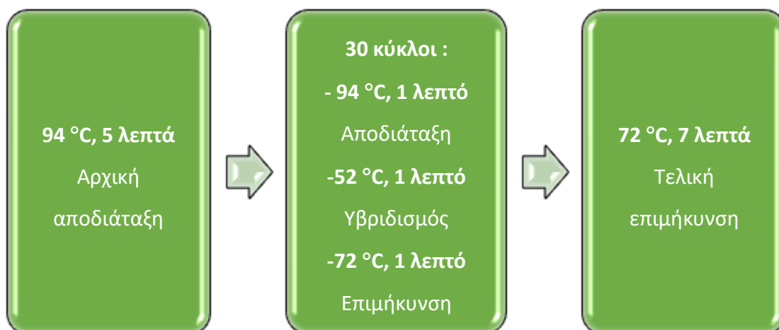
Εικόνα 2.5 Το πρόγραμμα που ακολουθήθηκε στην αλυσιδωτή αντίδραση της πολυμεράσης.
