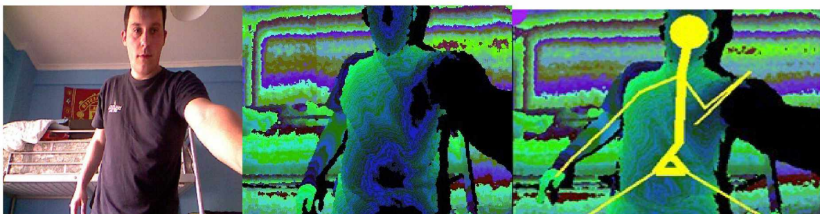
Εικόνα 6 : Από αριστερά προς τα δεξιά : α) RGB εικόνα, β) εικόνα βάθους, γ) εικόνα βάθους με σκελετική απεικόνιση
