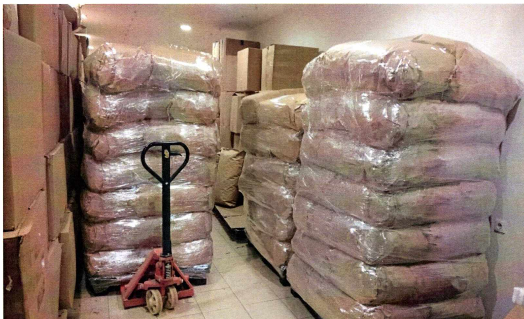
Εικόνα 1.28: Αποθήκευση σε χαρτοσακούλες και χαρτοκιβώτια και τοποθέτηση σε παλέτες
