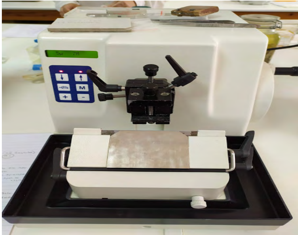
Εικόνα 6: Η μικροτόμος που χρησιμοποιήθηκε για την τομή των δειγμάτων (Πηγή: προσωπικό αρχείο)
