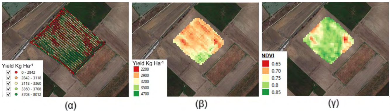
Εικόνα 2 (α) Πρωτογενή δεδομένα παραγωγής (β)Χάρτης παραγωγής μετά από καθαρισμό των περιθωρίων και resampling στα 10m (γ) εικόνα Sentinel-2 για τις 29/4 όπου απεικονίζεται ο NDVI για το αντίστοιχο χωράφι
