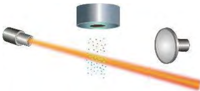
Εικόνα 30: Τελευταίο στάδιο της τεχνικής του ατομικού σιντριβανιού
