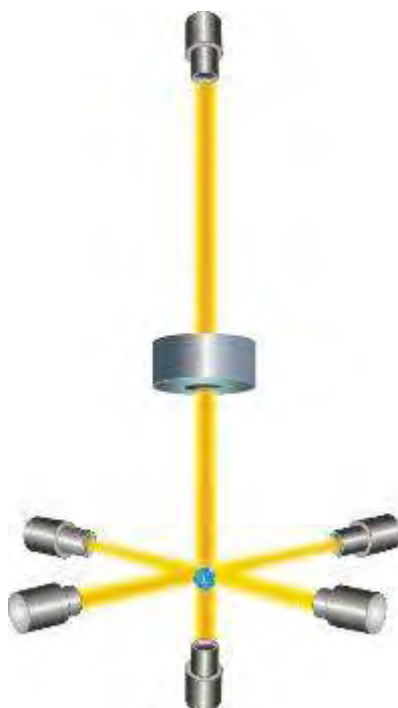
Εικόνα 27: Δέσμες λέιζερ, σε ορθή γωνία η μια προς την άλλη, σπρώχνουν άτομα καισίου ώστε να σχηματίσουν μια σφαίρα
