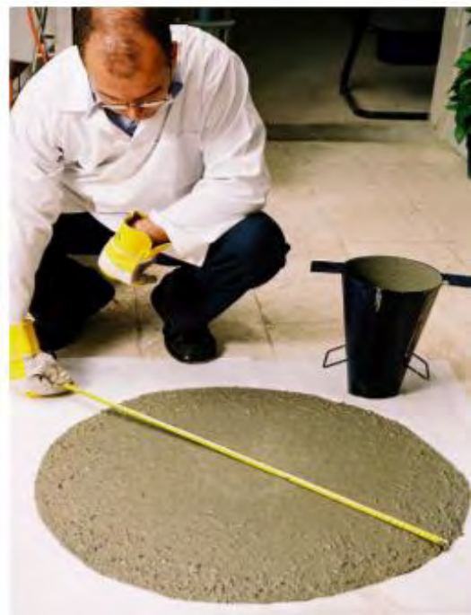
Εικόνες 4.1-4.2: Δοκιμή κώνου εξάπλωσης [πηγή: Sonebi and Yahia (2020)] και κατηγορίες σταθερότητας ΑΣΣ [πηγή: AASHTO-T-351 (2014)]
