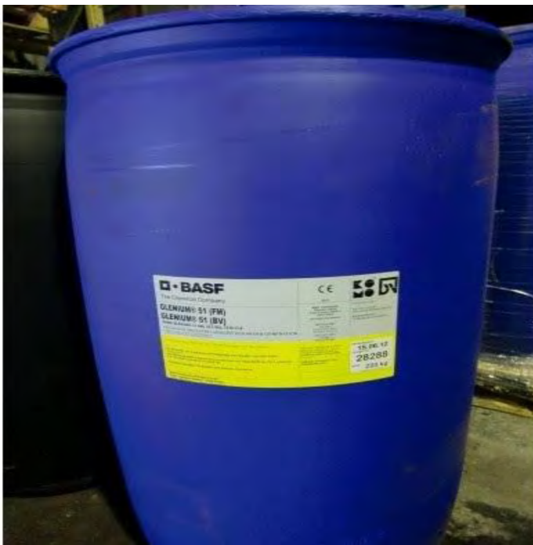
Εικόνα 3.8: Υδατικός μειωτήρας MasterGlenium 51 από την BASF [πηγή: Google Εικόνες]
