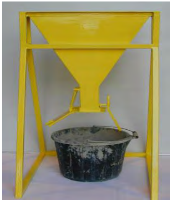
Εικόνα 4.3: Διάταξη V-χοάνης [πηγή: Sonebi and Yahia (2020)]
