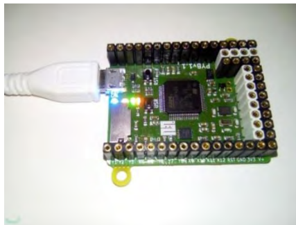
Εικόνα 25: Τέσσερα αναμμένα led που σημαίνει ότι η συνθήκη είναι True.
