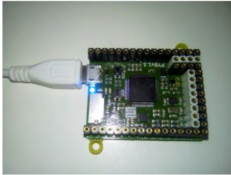
Εικόνα 27: Ένα αναμμένο led (μπλε) που σημαίνει ότι όλες οι συνθήκες είναι False.
