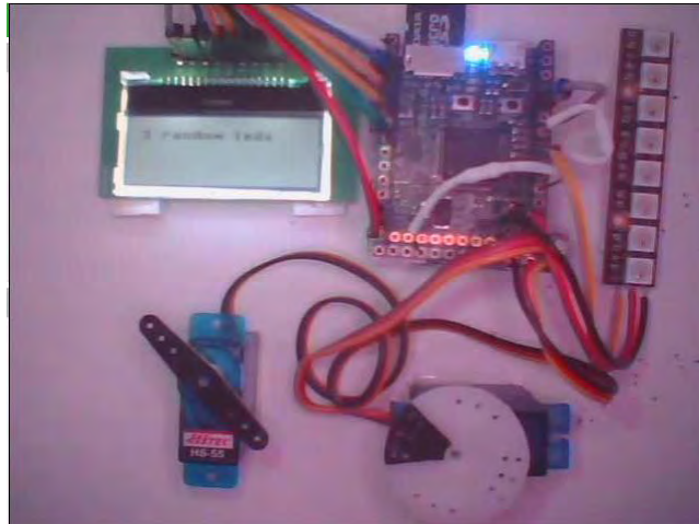
Εικόνα 34: Εμφάνιση του μηνύματος «Random leds» στην LCD οθόνη και άναμμα του μπλε led (τυχαίο) 46
