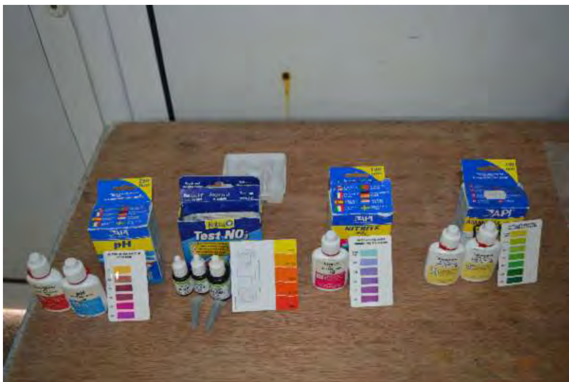
Εικόνα 16. Τυποποιημένα αντιδραστήρια test kit για τον έλεγχο και προσδιορισμό των χημικών παραμέτρων των ενυδρείων. Απο αριστερά προς τα δεξιά Αμμωνία, Νιτρικά, Νιτρώδη και pH. (Φωτογραφία συγγραφέων)
