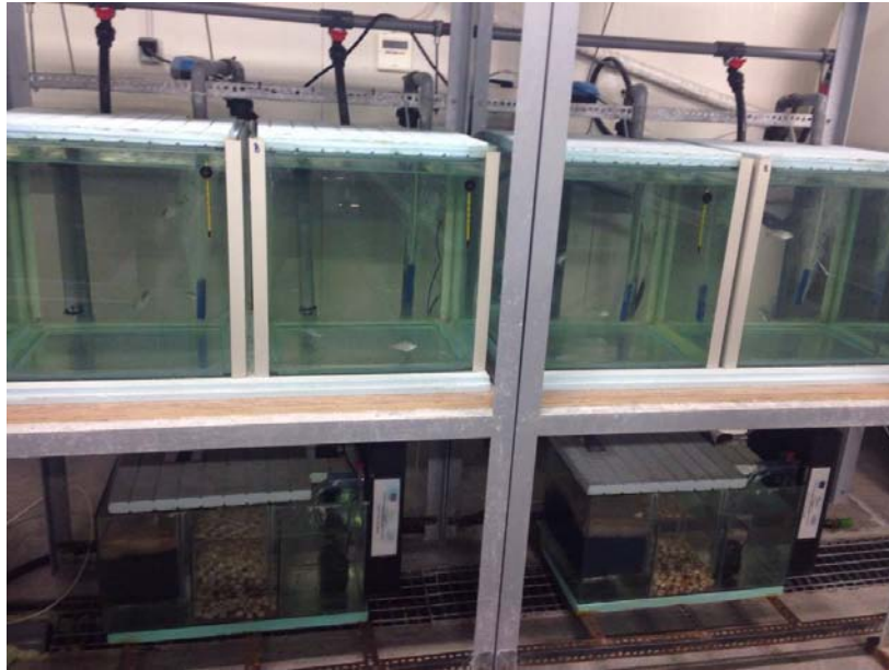
Εικόνα 2.1. Διάταξη δεξαμενών και απεικόνιση του συστήματος φιλτραρίσματος-αποστείρωσης.
