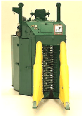
Εικόνα 1.2.1.2: Μηχανισμός συγκομιδής βαμβακιού.
