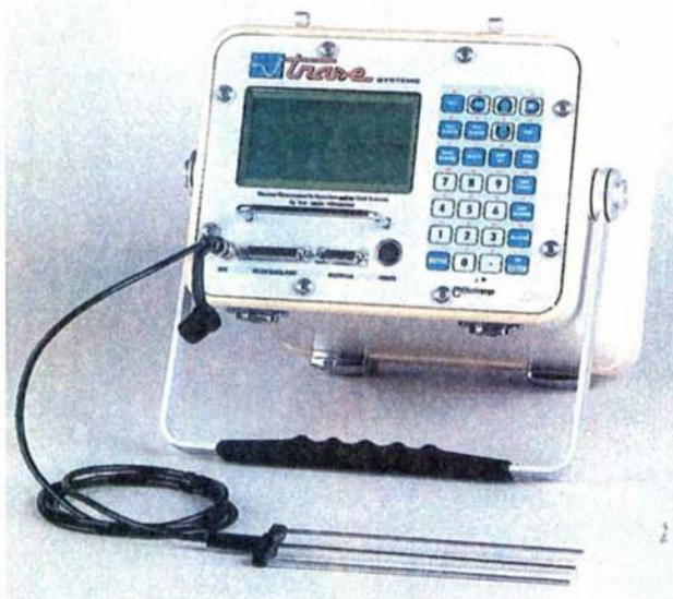
Εικόνα 2.1: Συσσκευή TRASE συνδεδεμένη με τον κυματοδηγό
