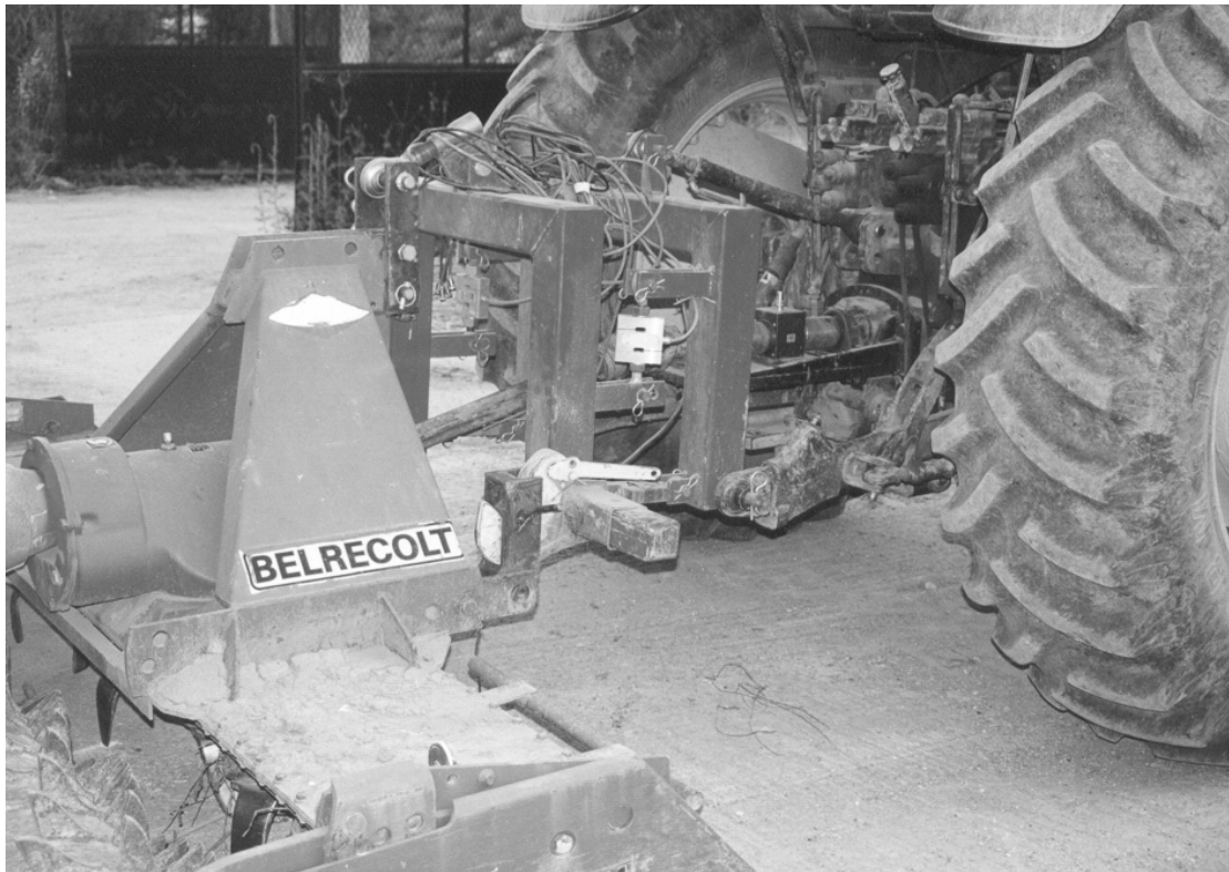
Σχήμα 5.2. Το σύστημα δυναμομέτρησης αναρτημένο στον ελκυστήρα
