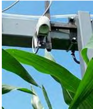
Εικόνα 2.8. Αισθητήρας που χρησιμοποιεί το Greenseeker
