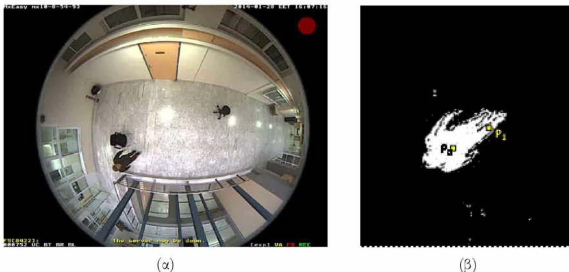
Σχήμα 3.1: Λήψη όρθιας στάσης του ανθρώπου μέσω ευρυγώνιας κάμερας, που είναι τοποθετημένη στην οροφή του δωματίου (α). Τμηματοποίηση της εικόνας και εξαγωγή της ανθρώπινης σιλουέτας, στην οποία εφαρμόζεται η μέθοδος εξαγωγής χαρακτηριστικών (β).
