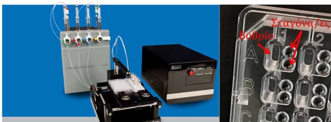
Εικόνα 29: Αριστερά, το ρομποτικό σύστημα OrghNano (Douglas Instruments). Δεξιά: Πιάτο 96 θέσεων δοκιμής διαφορετικών συνθηκών κρυστάλλωσης. Η συνθήκη κρυστάλλωσης τοποθετείται στο βοθρίο και η πρωτεΐνη με τη συνθήκη τοποθετούνται ταυτόχρονα στη θέση τοποθέτησης της σταγόνας.
