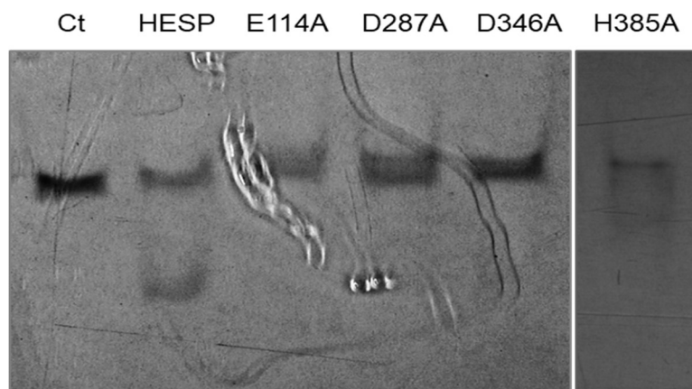
Εικόνα 21. Μέτρηση ενζυμικής δραστηριότητας των μεταλλαγμάτων της AtHESP με τη μέθοδο του φθορίζοντος υποστρώματος.
