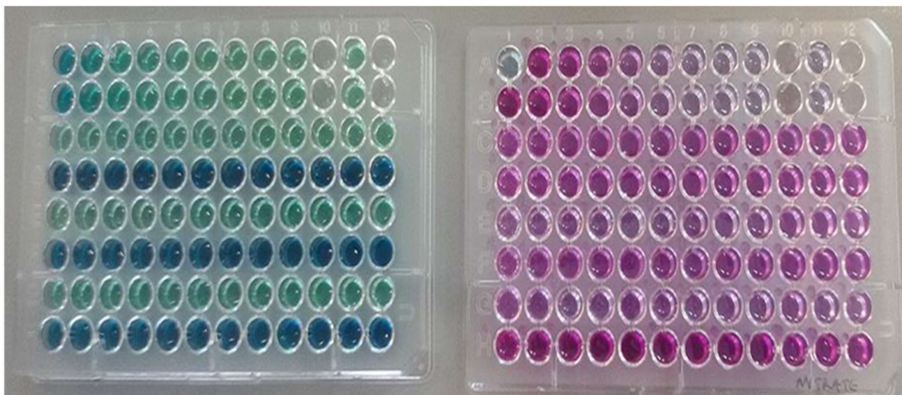
Εικόνα 7: Τα 96-well plate για τη μέτρηση \text{NH}_4^+ (αριστερά) και τα \text{NO}_3^- (δεξιά).
