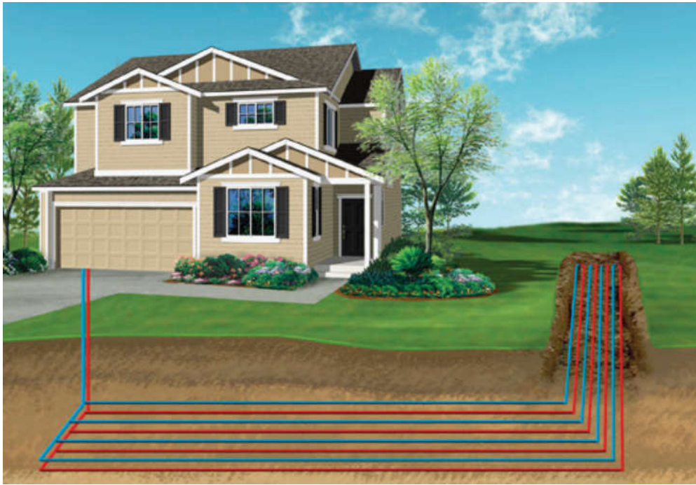
Σχήμα 3.5: Γεωθερμικό σύστημα οριζόντιου βρόχου (hydro.mb.ca).
