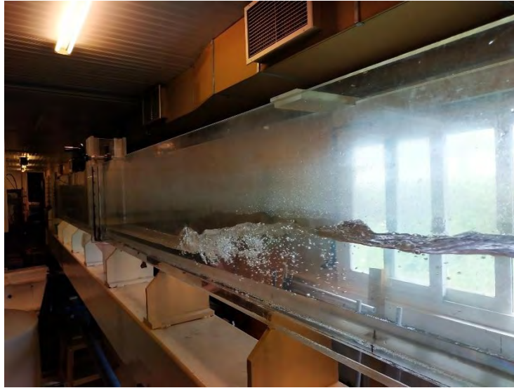
Εικόνα 7.1 Το υδραυλικό άλμα όταν το νερό ρέει προς τον εκχειλιστή
