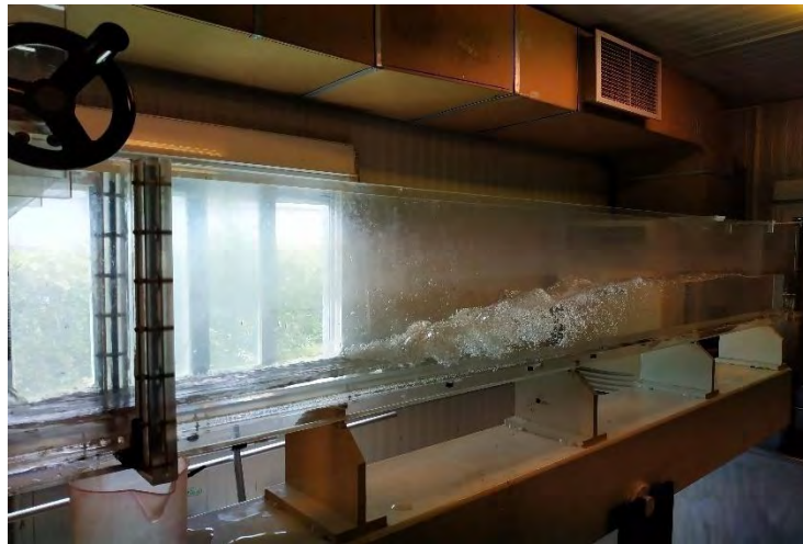
Εικόνα 7.2 Το υδραυλικό άλμα μετά την έξοδο του νερού από το θυρόφραγμα
