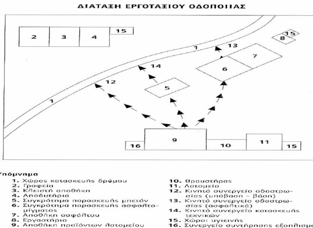
Εικόνα 1: Παραδείγματα διάταξης εργοταξίων
