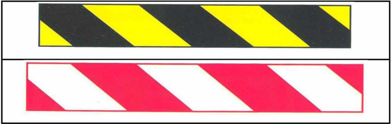
Εικόνα 17: Σήμανση εμποδίων, επικίνδυνων σημείων και οδών κυκλοφορίας
