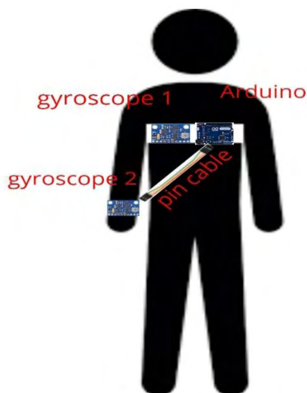
Εικόνα 9: Σημεία τοποθέτησης Gyro MPU πάνω στον χρήστη.
