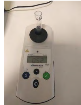
Εικόνα 13: Μέτρηση της πυκνότητας του εναιωρήματος με θολοσίμετρο.
