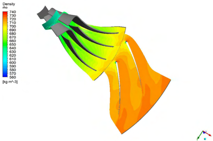
Εικόνα 54. Μεταβολή πυκνότητας κατά μήκος του συμπιεστή.
