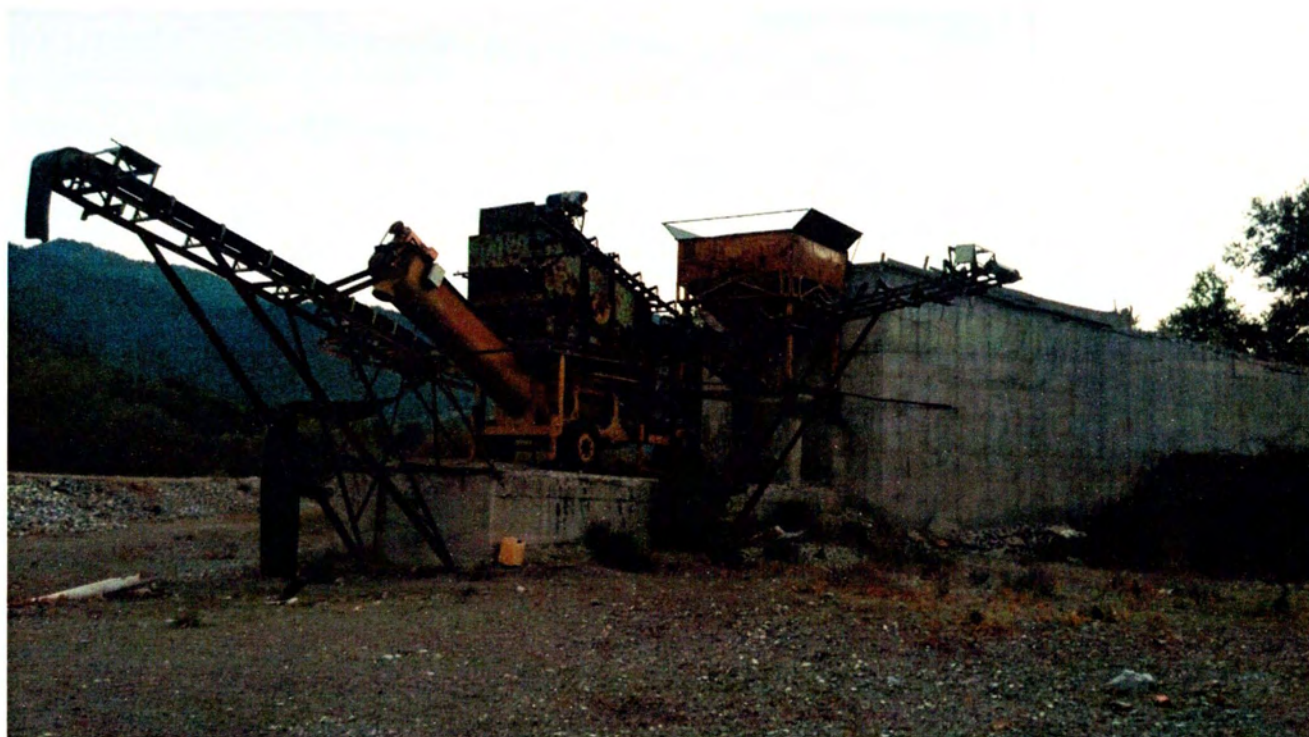
(Μονάδα διαχωρισμού ποταμίσιου χαλικιού, προσωπικό αρχείο)
