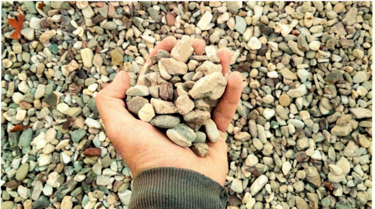
(Ποταμίσιας πέτρας και μπάζα πριν τη θλίψη, προσωπικό αρχείο)
