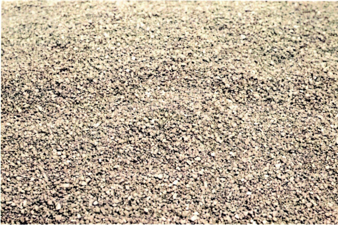
(Ποταμίσιες πέτρες και μπάζα μετά τη θλίψη, προσωπικό αρχείο)
