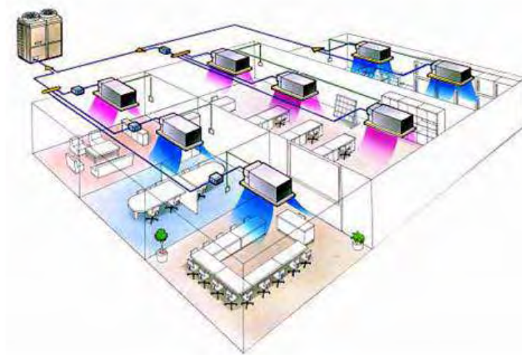
Εικόνα 4.16 Εγκατάσταση συστήματος VRV-VRF σε κτίριο [ΚΑΠΕ]
