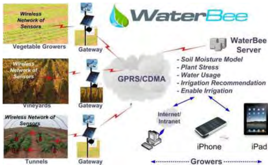
Εικόνα 4.26 Λειτουργία του έξυπνου συστήματος άρδευσης Waterbee [Google]
