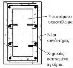
Σχήμα 2.8: Κλειστός μανδύας οπλισμένου σκυροδέματος σε υποστύλωμα [8].
