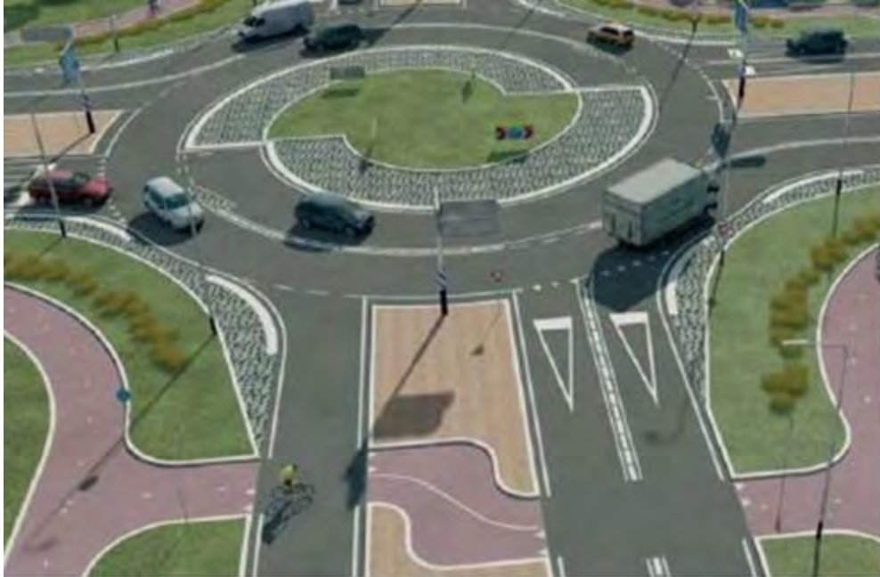
Εικόνα 1.1 Υπόδειγμα διαγράμμισης σπειροειδούς δακτυλίου κυκλοφορίας (turbo-Κυκλικός κόμβος)
