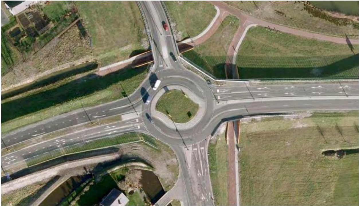
Εικόνα 4.4 Διασχιζόμενη επιφάνεια στην κεντρική νησίδα κυκλικού κόμβου τύπου turbo (Άμστερνταμ)
