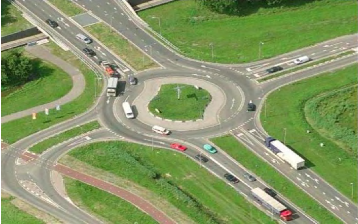
Εικόνα 4.5 Διαχωριστική νησιδα σε turbo κυκλικό κόμβο με ύπαρξη πρασίνου
