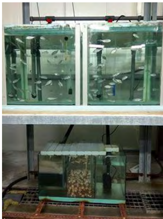
Εικόνα 2.1: Διάταξη δεξαμενών και απεικόνιση του συστήματος φιλτραρίσματος-αποστείρωσης.
