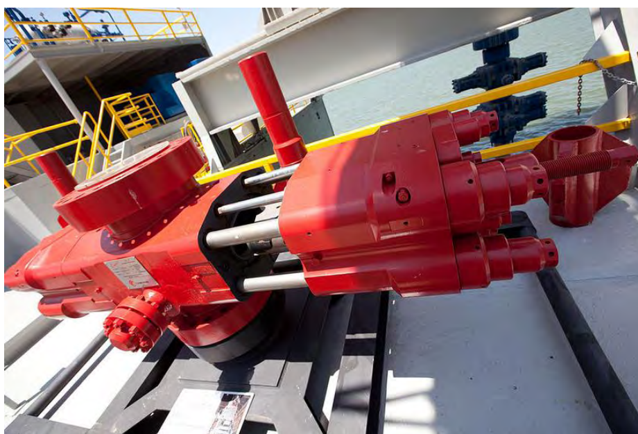
Εικόνα 69. Blow Out Preventer (BOP), παρεμποδιστής εκρήξεων.
