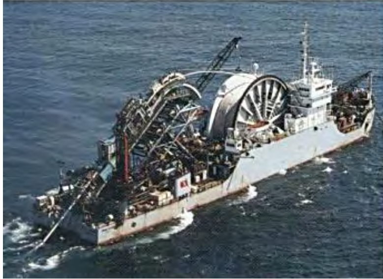
Εικόνα 80. Η μέθοδος Reel- lay.
