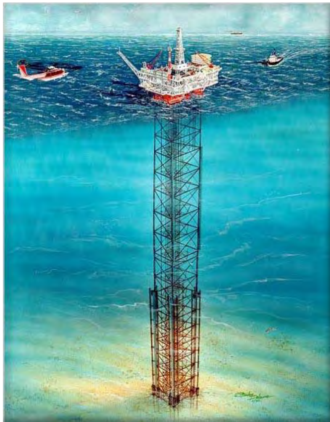
Εικόνα 59. Απεικόνιση της διάταξης ενός εύκαμπτου πύργου.
