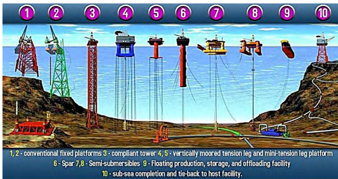
Εικόνα 51. Απεικόνιση όλων των ειδών των υπεράκτιων εγκαταστάσεων που χρησιμοποιούνται για την εκμετάλλευση των θαλάσσιων ενεργειακών πόρων.
