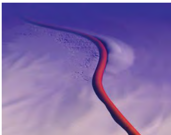
Εικόνα 77. Αστάθειες θέσεως υποθαλάσσιου αγωγού.
