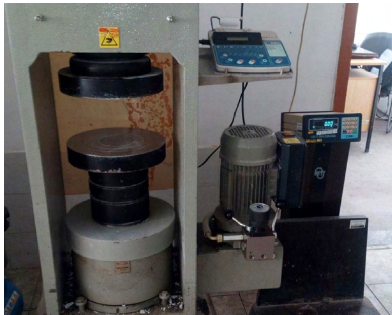
Σχήμα 2.31: Υδραυλική Πρέσσα για τη Μέτρηση της Ποιότητας Σκυροδέματος
