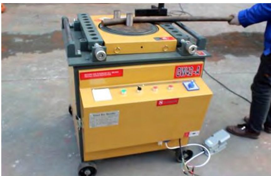
Σχήμα 2.13: Μηχάνημα «Κουρμπαδόρος» σε Εργοτάξιο
