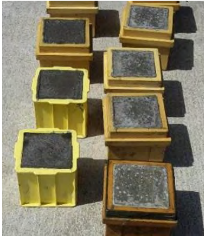
Σχήμα 2.30: Δειγματοληψία Σκυροδέματος Εργοταξίου με Δοκίμια
