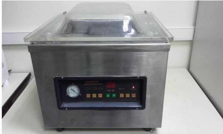
Εικόνα 2.3) Συσκευαστικό μηχάνημα που χρησιμοποιήθηκε για την συσκευασία των φιλέτων λαβρακιού σε ατμόσφαιρα κενού.
