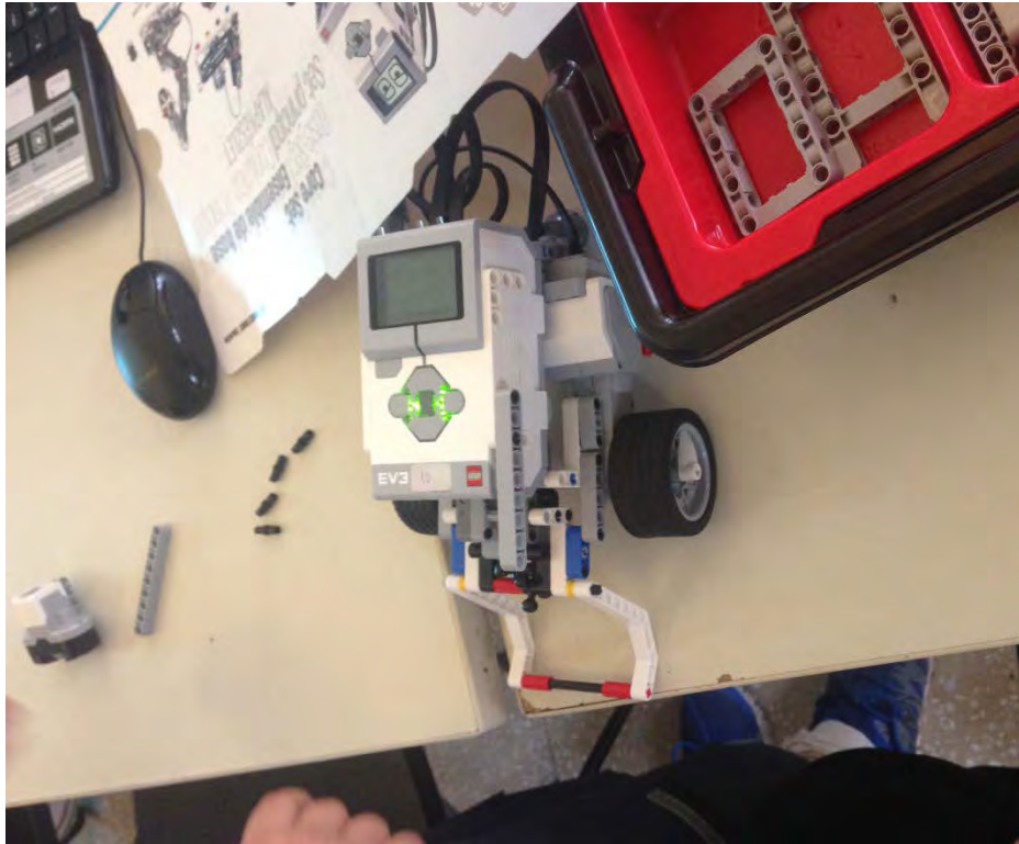
Εικόνα 2.3 Κατασκευή τύπου μπουλντόζα με Lego Ev3
