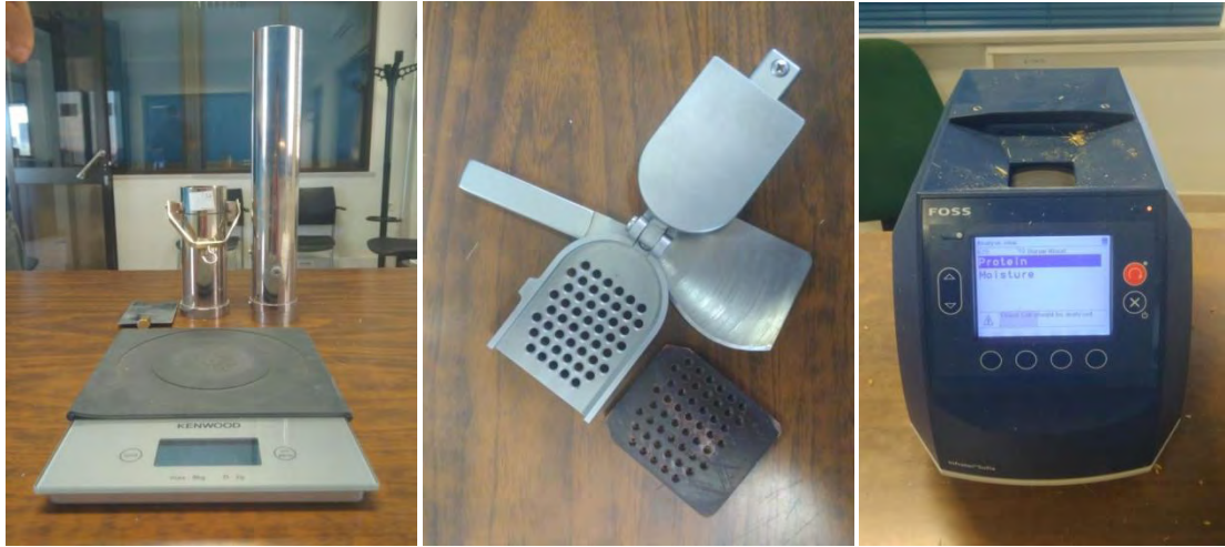
Εικόνα 8 Ζυγός ακριβείας και εκατολιτρικός ζυγός (αριστερά), φαρινοκόπτης 50 θέσεων (κέντρο) και συσκευή υπολογισμού ολικών πρωτεϊνών σκληρού σίτου της εταιρείας Foss (δεξιά)
