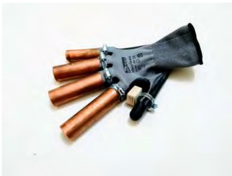
Εικόνα 24: Υλικά κατασκευής γάντια εργασίας, χαλκοσωλήνες, σφικτήρες.
