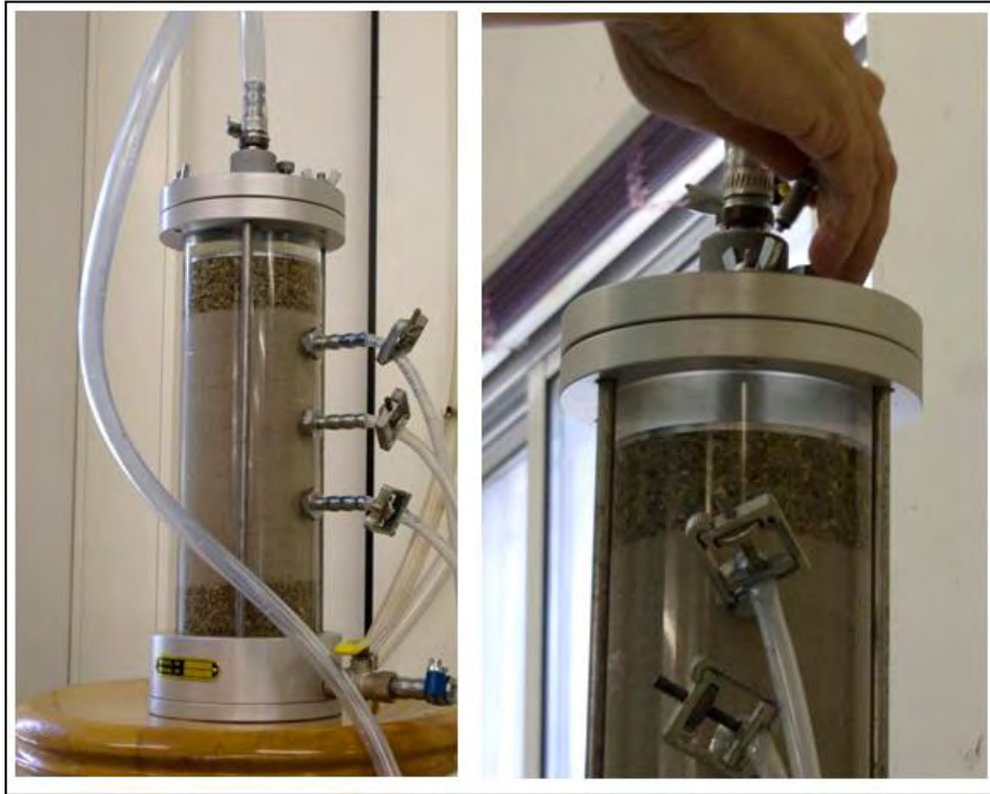
Σχήμα 4.28 Ολοκλήρωση κορεσμού και απαέρωση της κυψέλης
