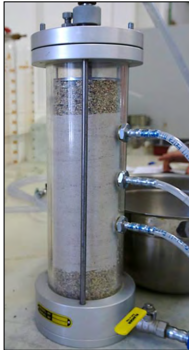
Σχήμα 4.24 Αεροστεγώς κλείσιμο της κυνέλης
