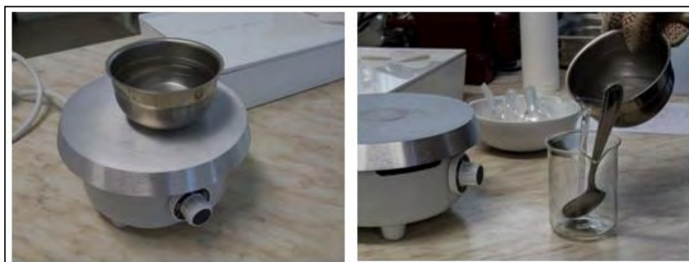
Σχήμα 5.14 Διαδικασία απαερισμού του αποσταγμένου νερού
