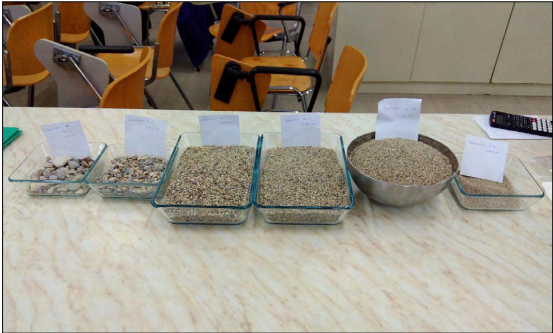
Σχήμα 4.11 Συλλογή συγκρατούμενων κόκκων από τη διαδικασία ανακίνησης
