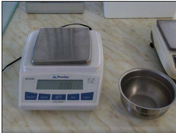
Σχήμα 5.9 Ζυγός με ακρίβεια 0,01 και υποδοχέας
