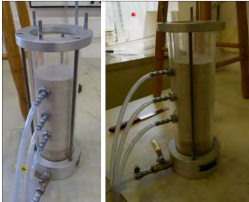
Σχήμα 4.22 Ολοκλήρωση τοποθέτησης δοκιμίου
