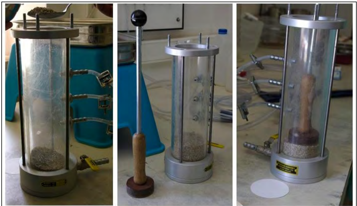
Σχήμα 4.19 Τοποθέτηση και συμπύκνωση εδαφικού φίλτρου
