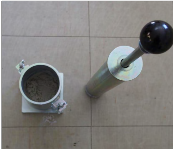
Σχήμα 5.27 Κάτοψη συμπυκνωμένου δείγματος
