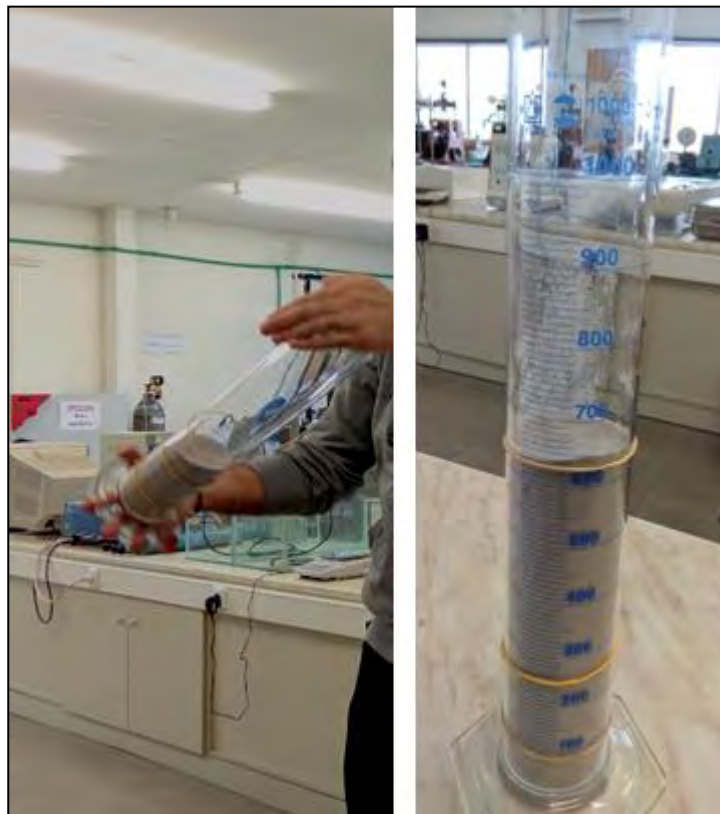
Σχήμα 5.19 Ανακίνηση κυλίνδρου πάνω-κάτω, τοποθέτηση στο πάγκο και προσαρμογή του πλαστικού λάστιχου
