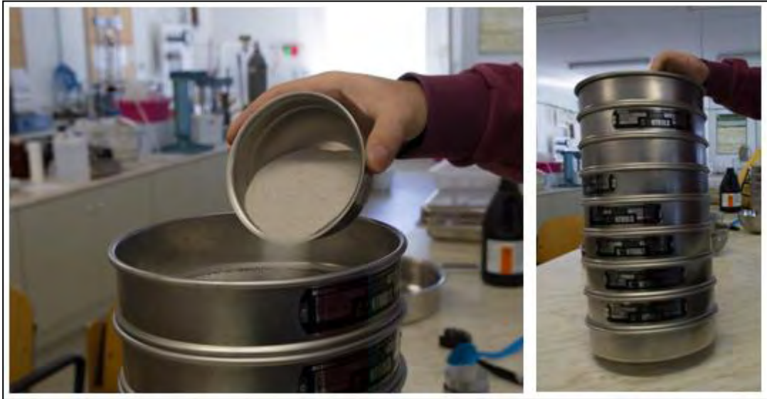
Σχήμα 5.11 Τοποθέτηση δείγματος στη σειρά κοσκίνων και διαδικασία ανακίνησης
