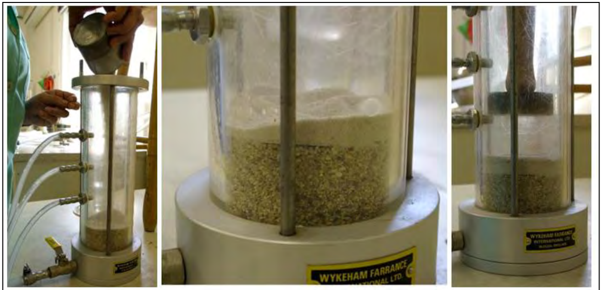
Σχήμα 4.21 Τοποθέτηση και συμπύκνωση δοκιμίου σε στρώσεις
