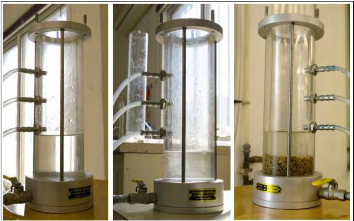
Σχήμα 4.15 Διαδικασία εξέτασης αναγκαιότητας χρήσης και χάρτινου και εδαφικού φίλτρου
