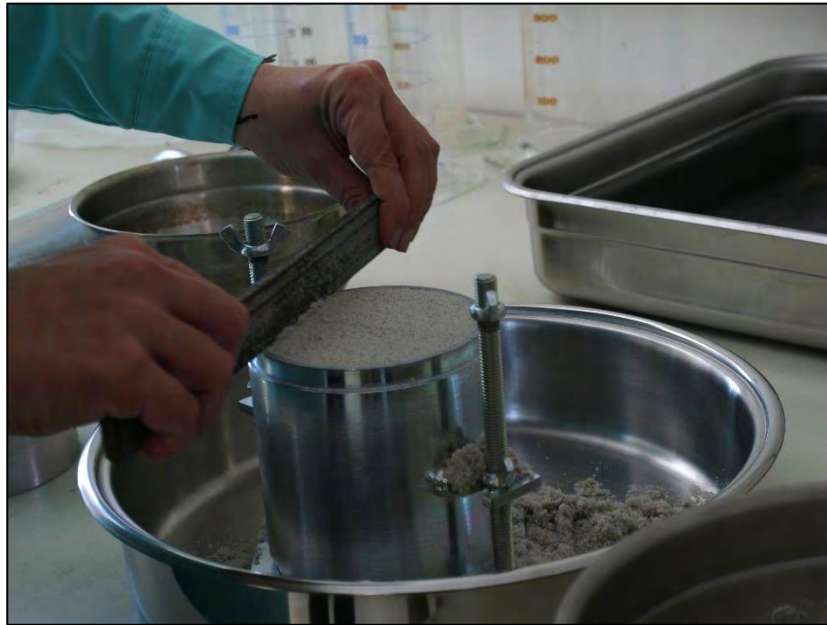
Σχήμα 5.28 "Ξύρισμα" του συμπυκνωμένου δείγματος
