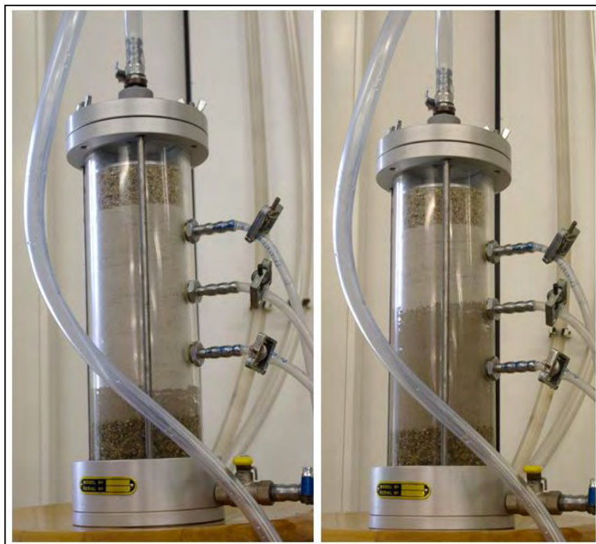
Σχήμα 4.27 Κορεσμός δοκιμίου με φορά από κάτω προς τα πάνω
