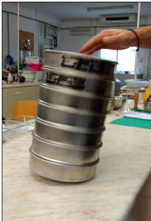
Σχήμα 4.10 Διαδικασία ανακίνησης των κοσκίνων
