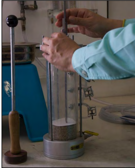
Σχήμα 4.20 Εκ νέου τοποθέτηση χάρτινου φίλτρου και καταγραφή βάθους
