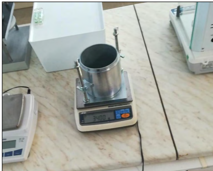
Σχήμα 5.23 Ζύγιση της βάσης της μήτρας
