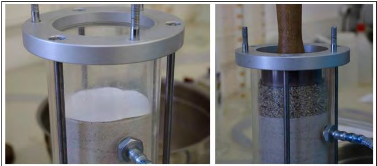
Σχήμα 4.23 Τοποθέτηση χάρτινου και εδαφικού φίλτρου στο άνω μέρος του δοκιμίου
