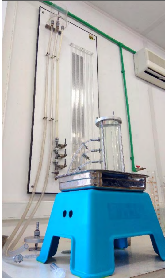
Σχήμα 4.8 Διαπερατόμετρο γεμάτο με νερό κατά τη διαδικασία βαθμονόμησης
