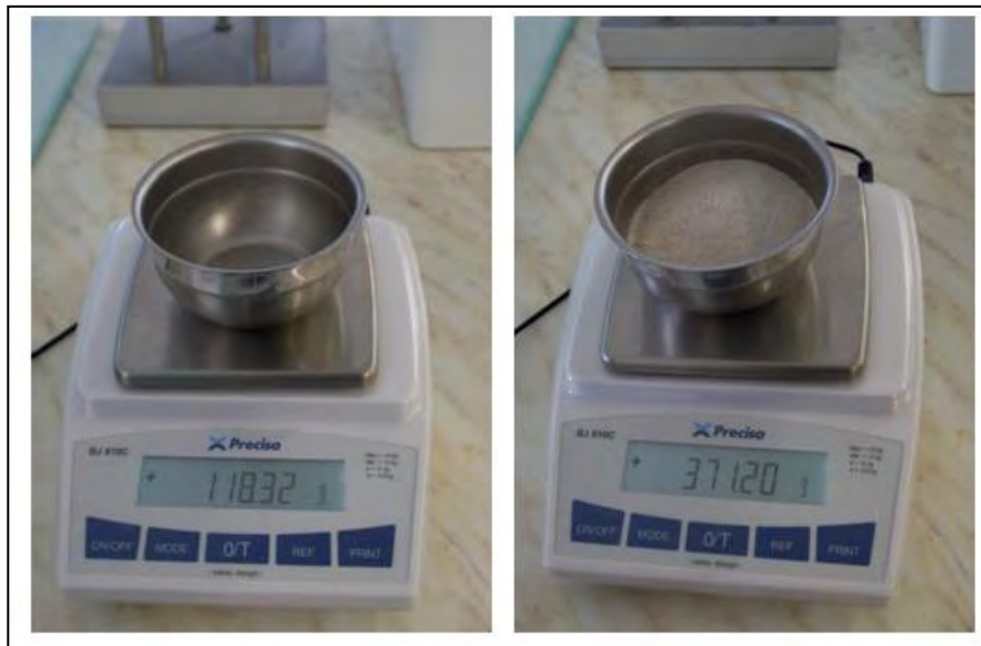
Σχήμα 5.10 Μέτρηση μάζας επιλεγμένου δείγματος άμμου M31
