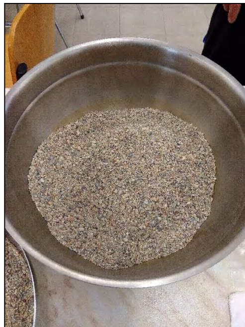
Σχήμα 4.12 Τελικό εδαφικό φίλτρο το οποίο προκύπτει από τη σύνθεση των παραπάνω κόκκων σε κατάλληλη αναλογία
