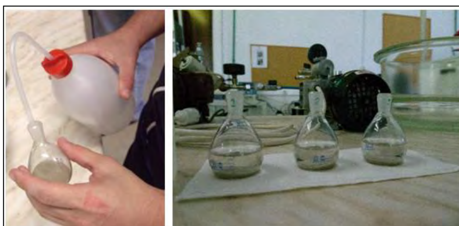
Σχήμα 5.15 Γέμισμα ληκύθων με απαερωμένο νερό περίπου ως τη μέση (να καλύπτεται το έδαφος)
