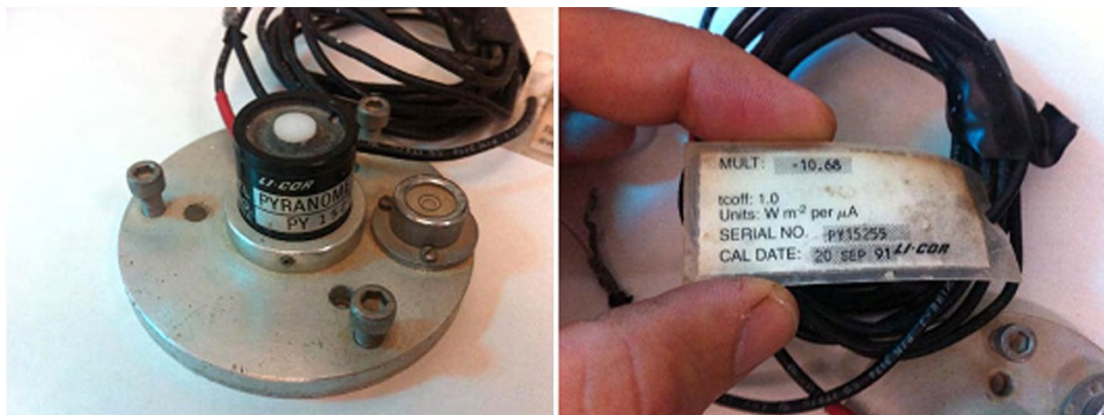
Εικόνα 2.1-1 Αισθητήριο LI COR και τύπος μετατροπής σε W m^{-2} per \mu A
